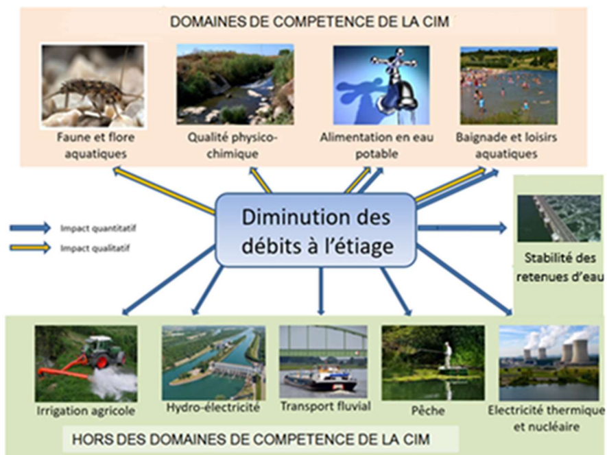
Figure 44 : Schéma de principe des impacts des étiages sur l'état des eaux et les usages
