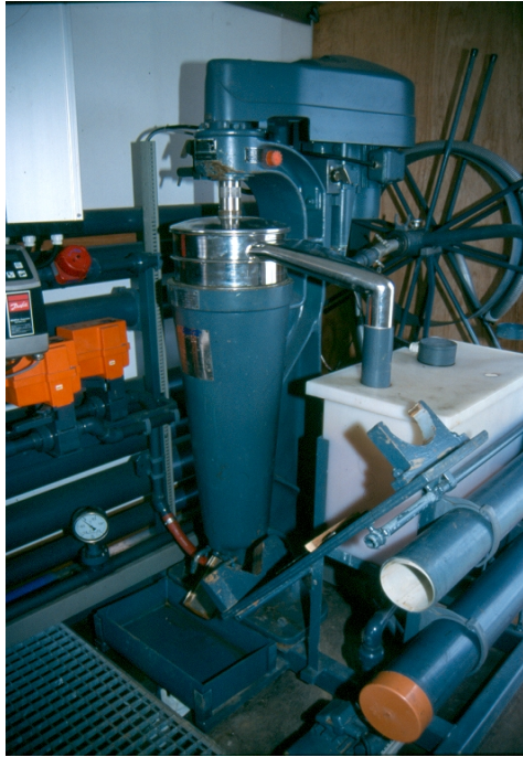
Foto 1: Die Zentrifuge (Quelle: VMM) Foto 2: Positionierung des Schwimmers und des Saugkorbs (Quelle: VMM)
